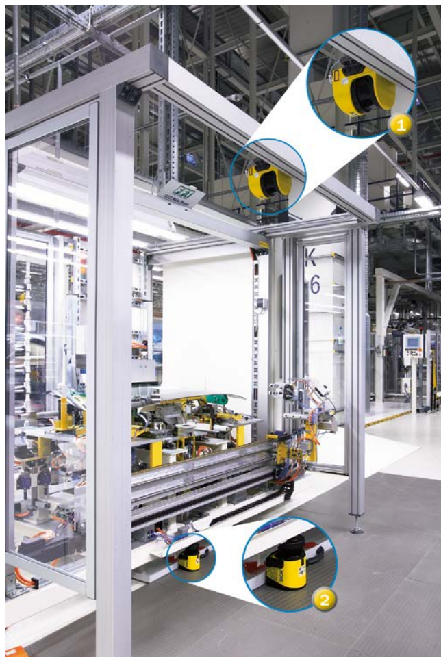
加工站的安全激光扫描器承担 “触发停止” 安全功能 (序号 1) 和 “防止启动” 安全功能 (后方进入防护) (序号 2)
