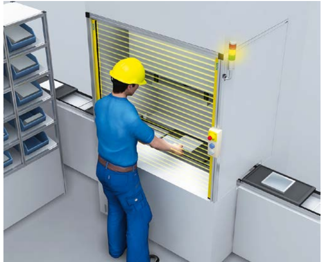
自动装配机上采用安全光幕的单次遮光 PSDI 模式。放料时，工具位于顶点。操作人员离开保护区域后，装配流程开始。
