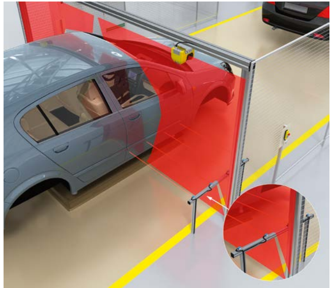
利用安全激光扫描器、垂直保护区域和借助适当布置的传感器切换保护区域实现物料通过
