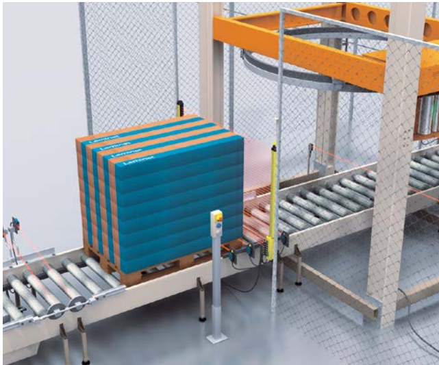
缠绕包装机上利用安全光幕和屏蔽传感器的屏蔽功能
